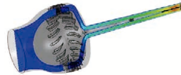
Fig. 11 Numero de Mach en el separador supersónico con generador de swirl.
