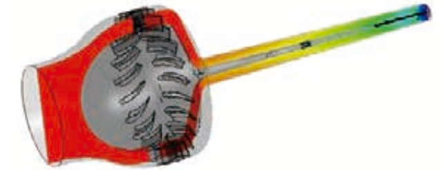
Fig. 13 Presión en el separador con generador de swirl.
