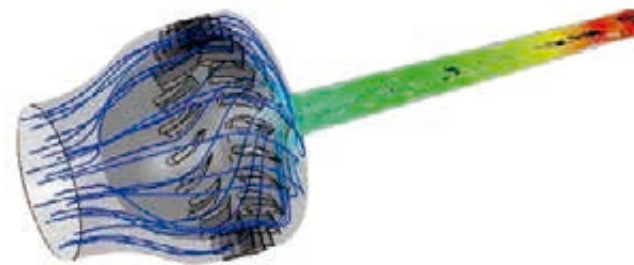
Fig. 10 Líneas de flujo en el separador con generador de swirl.
