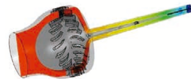
Fig. 12 Temperatura en el separador con generador de swirl.
