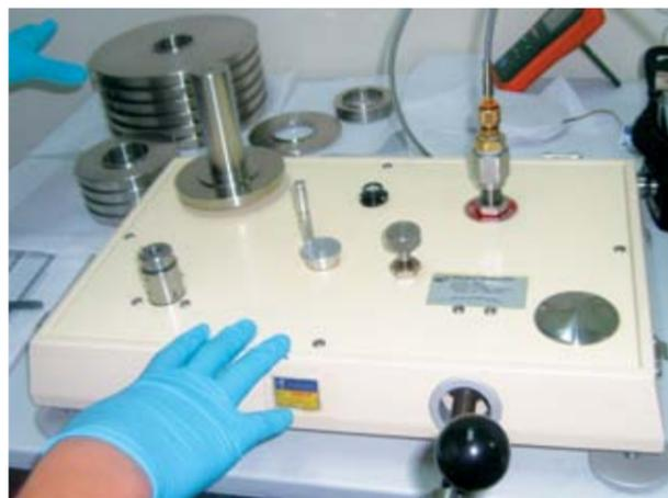
Fig 1. Patrón Tipo Balanza de Presión Corporación CDT de GAS
