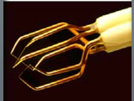
Arriba: Anemómetro de Hilo Caliente Abajo: Sonda Triaxial CTA http://news.thomasnet.com/companystory/Economical-Hot-Wire-Anemometer-Series-HHF42-823026
