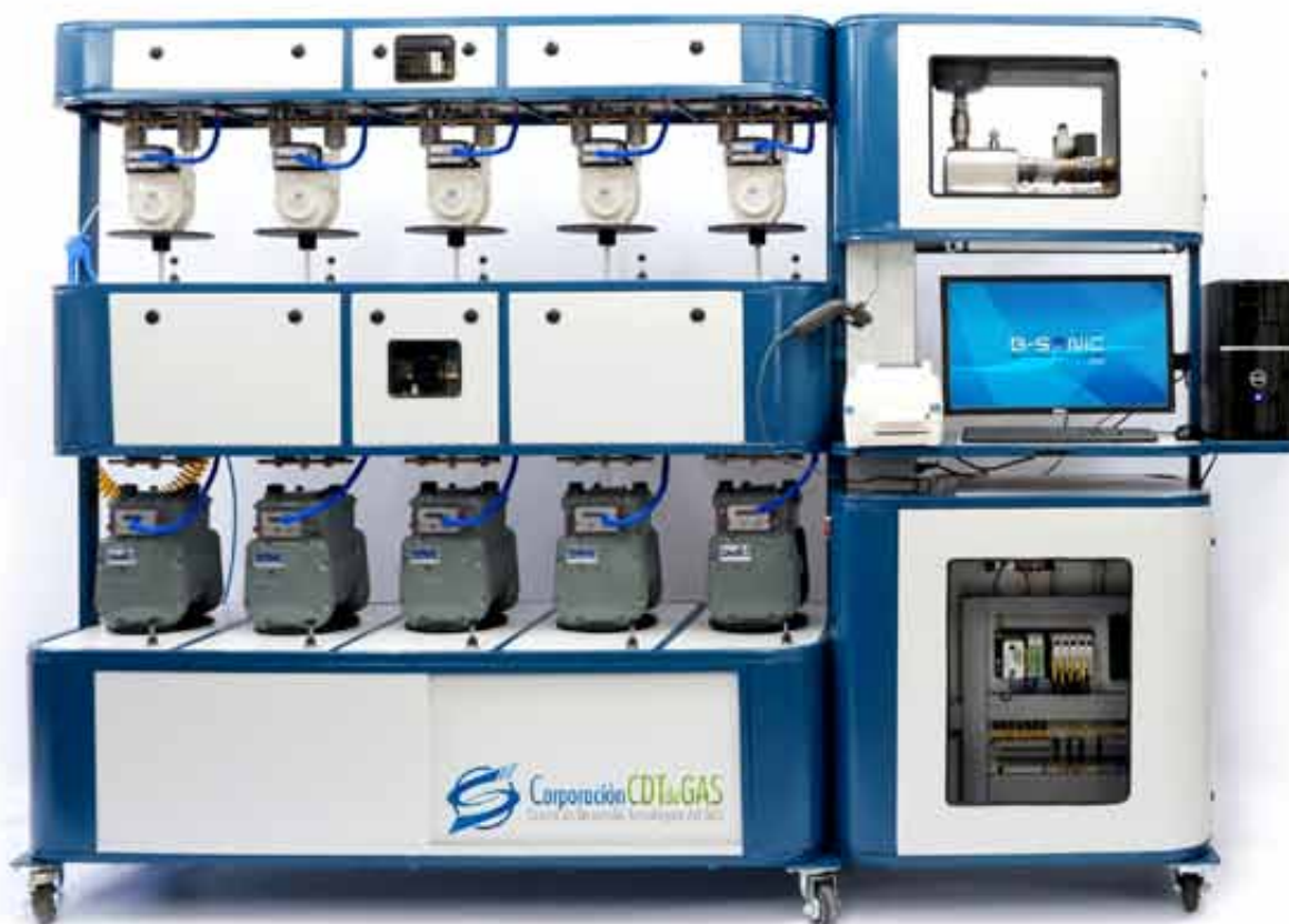
Figura 1. Banco de Boquillas Sónicas para Calibración de Medidores de Gas desarrollado por el CDT de GAS de Colombia
