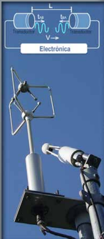
Anemómetro Ultrasonico-Principio Tiempo de Tránsito http://en.wikipedia.org/wiki/File:Eddy_Covariance_IRGA_Sonic.jpg
