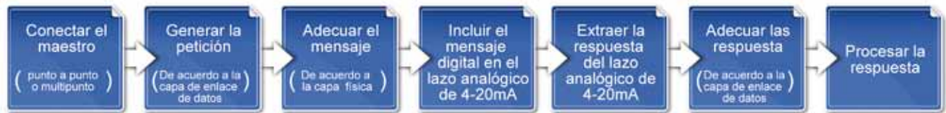
Figura 8. Pasos para establecer comunicación con un dispositivo HART
