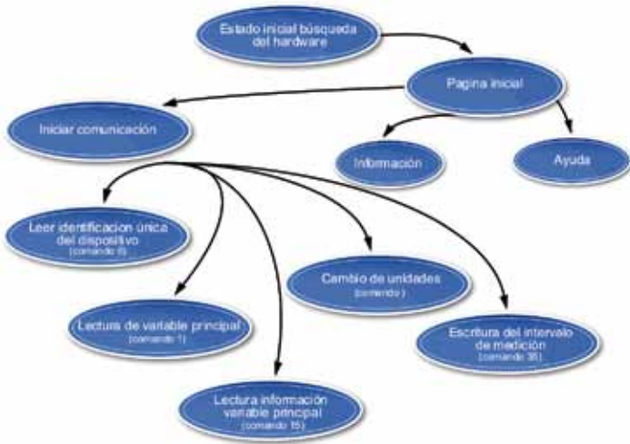
Figura 15. Diagrama de estados software teléfono móvil.
