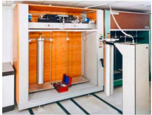
Figura 2. Balanza de dos platos utilizada en el Federal Institute for Material Testing (BAM) de Alemania
