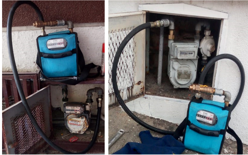
Figura 6. >> Medidores en verificación posterior – Patrones volumétricos calibrados en Laboratorio Acreditado ONAC.
