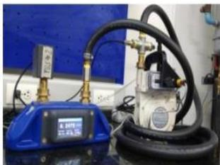
Desarrollo de nuevos patrones portátiles para calibración o verificación de medidores *in situ* y uso de IoT como sistema de adquisición de datos.
