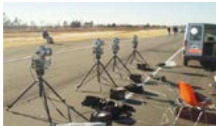
Figura 1. INTI verificando cinemómetros en autódromo
