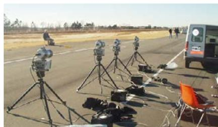
Figura 1. INTI verificando cinemómetros en autódromo
