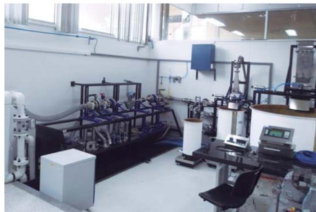
Figura 6. Sistema patrón gravimétrico de la Corporación CDT de GAS<sup>13</sup>
