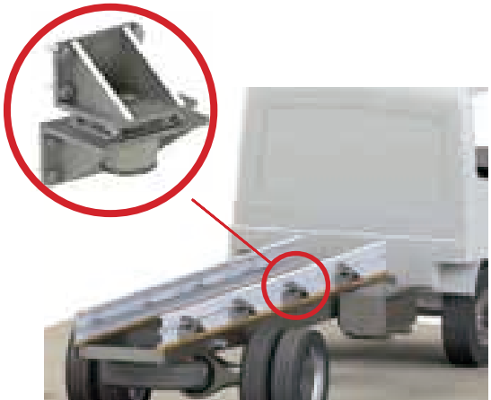
Figura 2. Sistemas anti-vibratorios implementados en el VALM para la reducción de impactos
