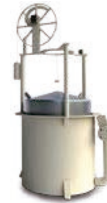
Figura 5. CAMPANA GASOMÉTRICA Fuente: Corporación CDT de GAS
