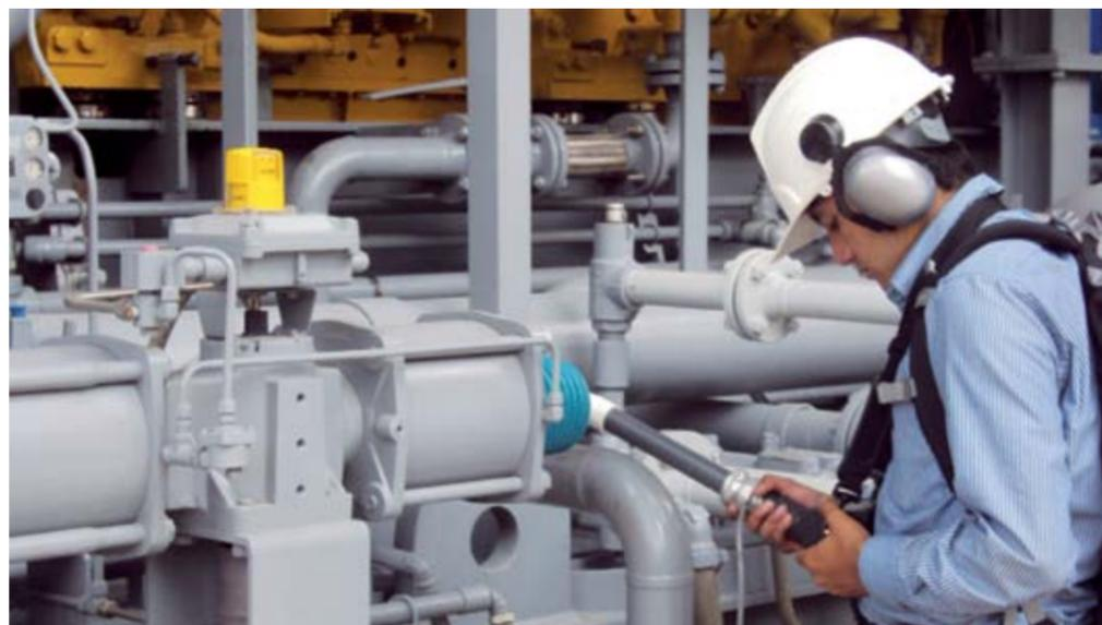
Fig. 2 Muestreo de alto caudal en un actuador neumático.
