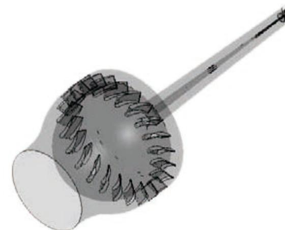
Fig. 6 Separador supersónico con generador de swirl.
