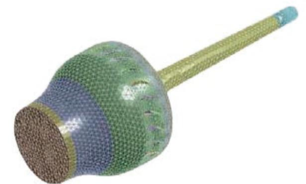
Fig. 7 Ejemplo de malla para separador supersónico.
