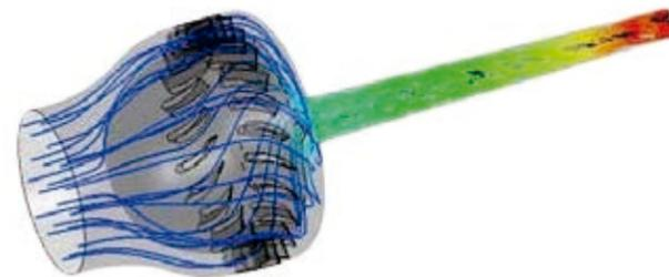
Fig. 10 Líneas de flujo en el separador con generador de swirl.
