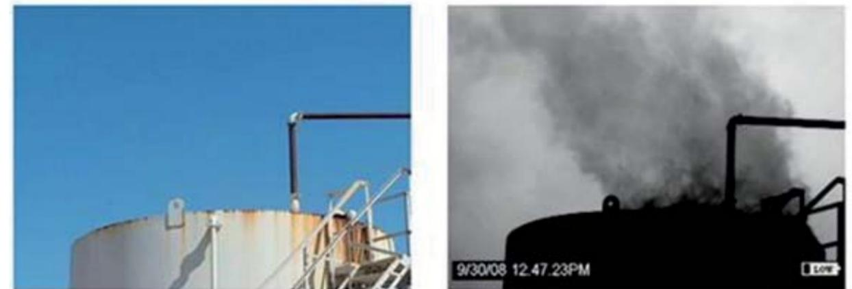
Figura 2. Imagen de un tanque de condensado con una cámara normal (izquierda) y con una cámara infrarroja (derecha)
