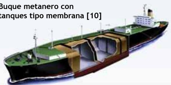
Figura 7. Buque tipo tanque esférico y tipo membrana.
