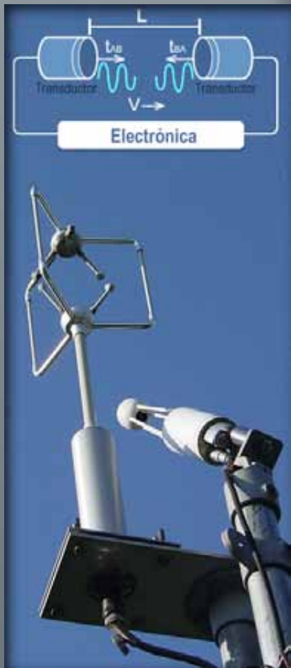
Anemómetro Ultrasonico-Principio Tiempo de Tránsito http://en.wikipedia.org/wiki/File:Eddy_Covariance_IRGA_Sonic.jpg
