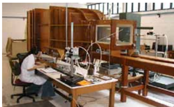
Figura 2. Túnel de viento de circuito abierto y flujo inducido (IPT en Sao Paulo)
