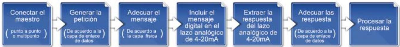
**Figura 8.** Pasos para establecer comunicación con un dispositivo HART
