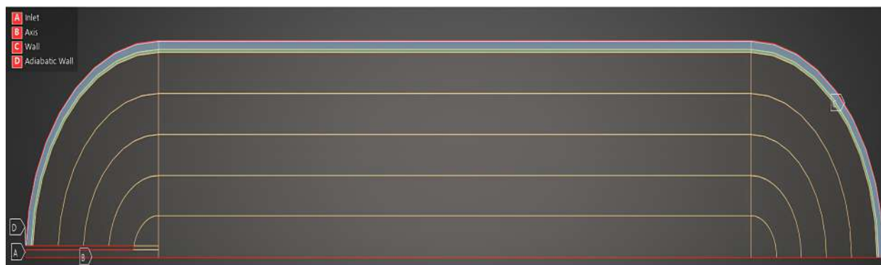
Figura 4. Zonas de referencia. Inlet (A) es la entrada de flujo másico, Axis (B) es el eje de simetría, Wall (C) es la pared de frontera y Adiabatic wall (D) es la pared adiabática.
