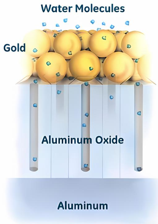
**Figura 3.** Estructura del sensor de óxido de aluminio [14].
