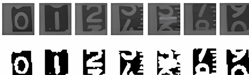
**Figura 11.** Ejemplificación del proceso de thresholding.
