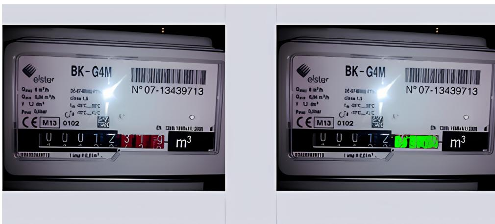
**Figura 9.** Localización de parte roja del contador. Recuperada de [6].
