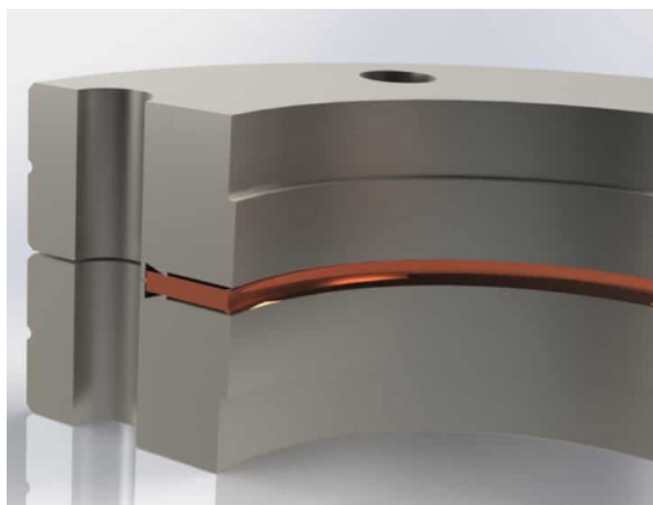
Figura 5. >> Corte transversal donde se aprecia el sello metálico en bridas CF [20].
