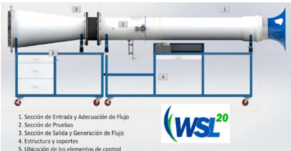
*Figura 1. Túnel de viento WSL 20. Fuente: Corporación CDT de Gas.*
