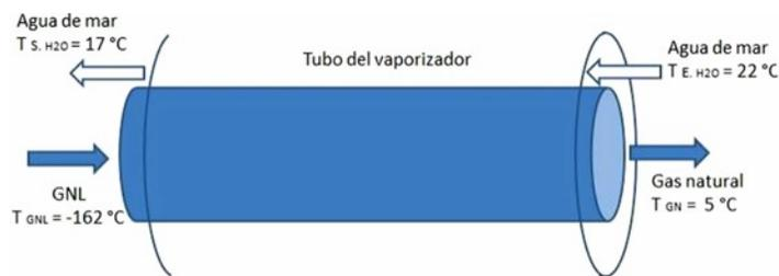
Figura 4. Dirección de los fluidos en el tubo del vaporizador
