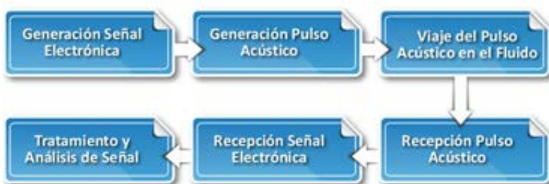
Fig 3. Sistemas que conforman la medición de flujo utilizando ultrasonido
